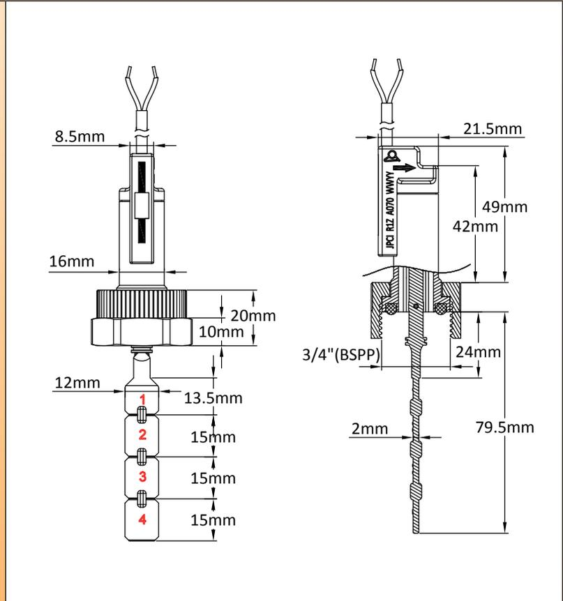
**Utilizzi principali:** Applicazioni in grandi quantità per il rilevamento del flusso nei circuiti elettronici a bassa tensione. Il modello più economico. La posizione di montaggio consigliata è su tubi orizzontali. Può essere montato in qualsiasi posizione con una piccola deriva nella calibrazione a causa del peso della paletta. Può essere utilizzato su tubi dell'acqua con **diametro da 15 a 100 mm**.
